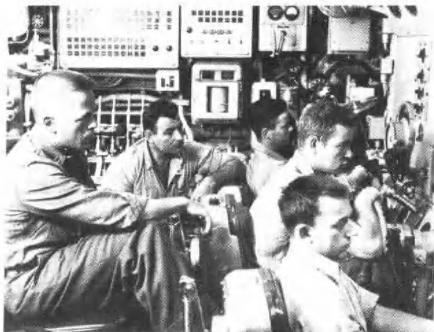
潛艦控制室，士兵可以在三個部位控制潛艦的航向，以及上浮或下潛的速率。(U.S. Navy)
