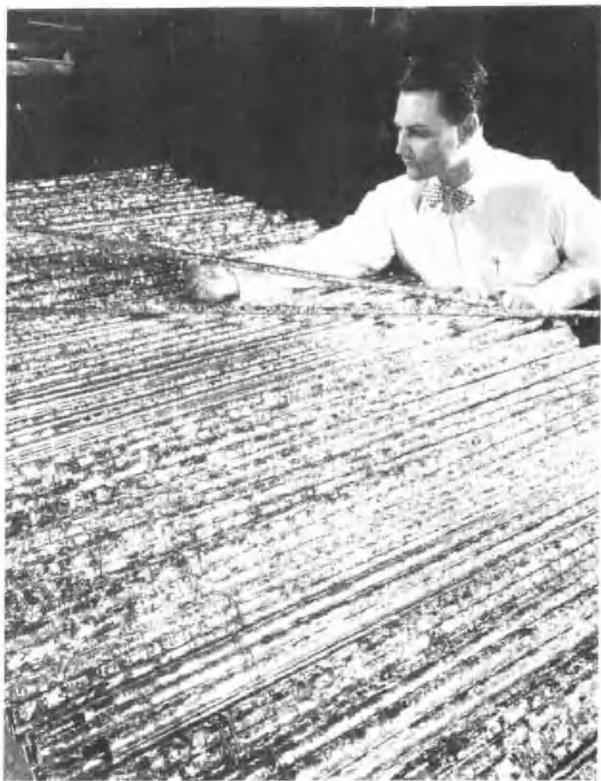
亞歷山大·史快爾，是西屋公司派駐在政府所屬貝蒂斯原子能實驗室的工程師，正在檢查一些首批量產的鈷晶棒。鈷晶棒再轉製成鵝鵝螺號原型反應器所需的核燃料。(Westinghouse)
