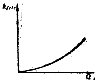
图1-4 气体的摩擦损失与流量的关系
