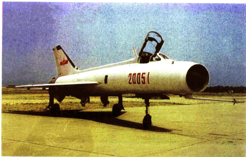
歼-8 (F-8) 中国沈阳飞机研究所和沈阳飞机制造公司共同研制的单座、双发高空高速战斗机。1969年7月5日原型机首飞，主要用于国土防空和夺取前线制空权。是中国自行设计生产的第一种歼击机。有歼-8 (白天型)、歼-8 I (全天候型) 两种主要型别。后来又在歼-8 I 的基础上研制出歼-8 II 型歼击机。
