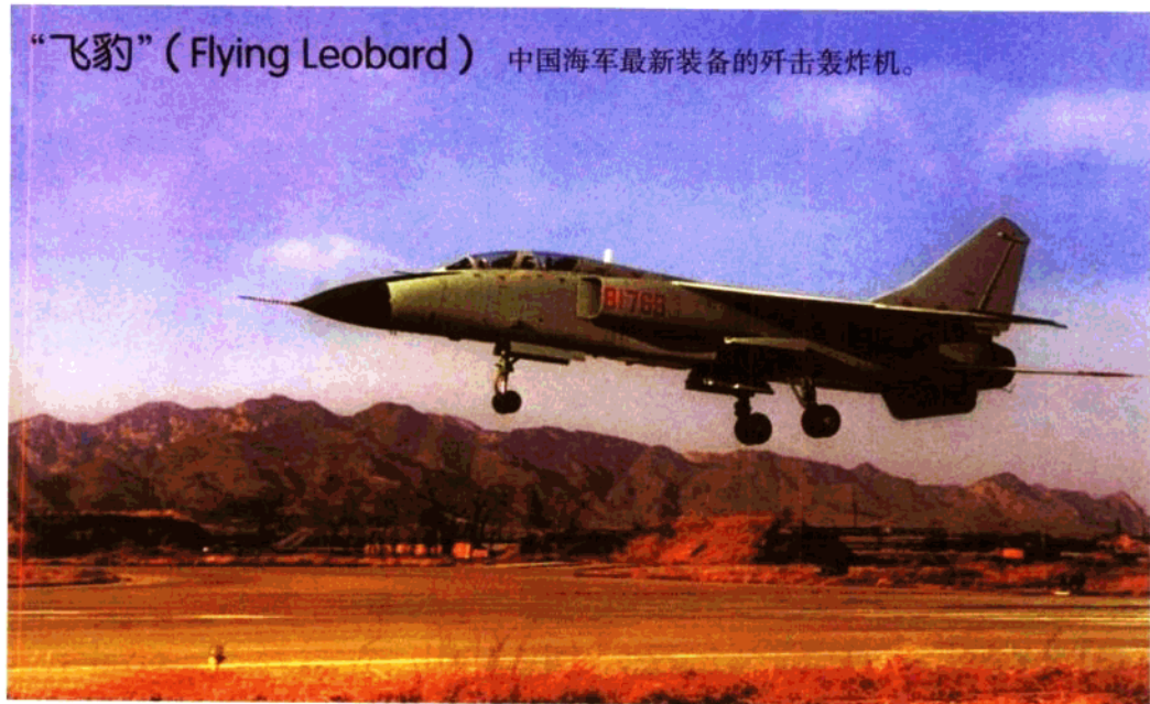
歼-8 (F-8) 中国沈阳飞机研究所和沈阳飞机制造公司共同研制的单座、双发高空高速战斗机。1969年7月5日原型机首飞，主要用于国土防空和夺取前线制空权。是中国自行设计生产的第一种歼击机。有歼-8 (白天型)、歼-8 I (全天候型) 两种主要型别。后来又在歼-8 I 的基础上研制出歼-8 II 型歼击机。
