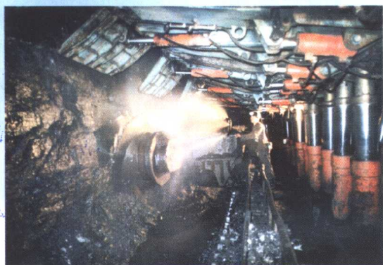
综采放顶煤工作面
