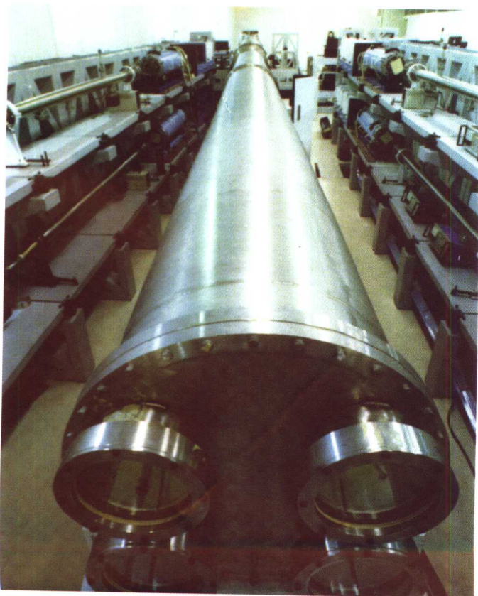
中国研制的用于激光核聚变研究的“神光Ⅱ”装置
