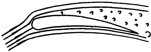
图 1-5 翼型的失速
