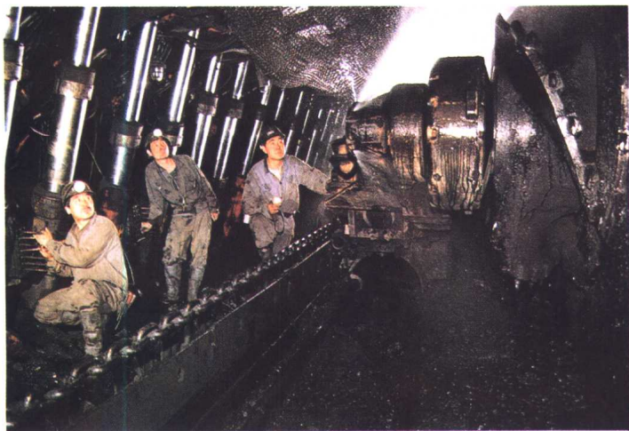
邢台煤矿金属网分层开采 3.2m 支架 综采工作面
