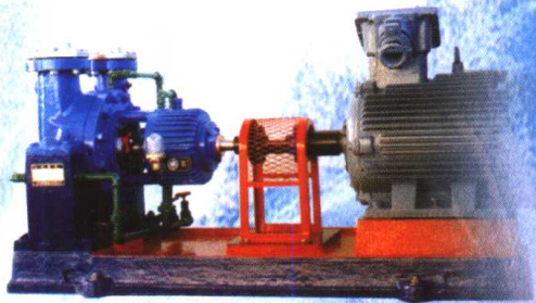
AYR 型化工流程泵: 该泵适于炼厂及石油化工装置的工艺流程, 输送不含固体颗粒的石油、液化石油气和其他介质。流量范围: 2.6 \sim 600 \text{ m}^3/\text{h} , 扬程: 30 \sim 330 \text{ m} , 工作温度: -45^\circ\text{C} \sim +420^\circ\text{C} 。该泵属国家级新产品。
