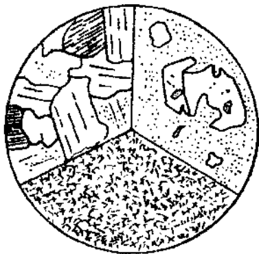
图 1-5 根据结晶程度划分的三种结构
