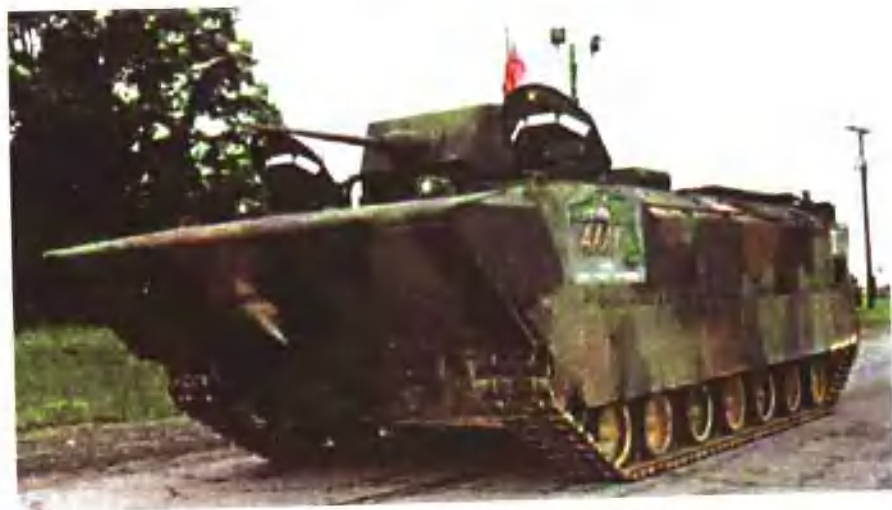
AAAV先进两栖突击车是水上速度最快的 两栖突击车，最大速度达46千米/小时
