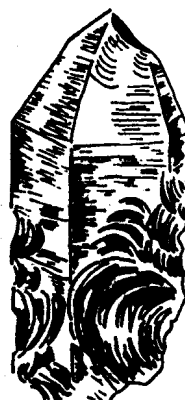
图1-3 单晶石英的贝壳状断口
