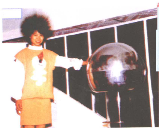
▲ 图3 人体带电后头发竖起并散开
