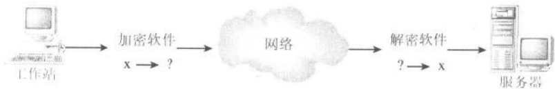
图1.1 利用加密技术实现安全的数据通信
