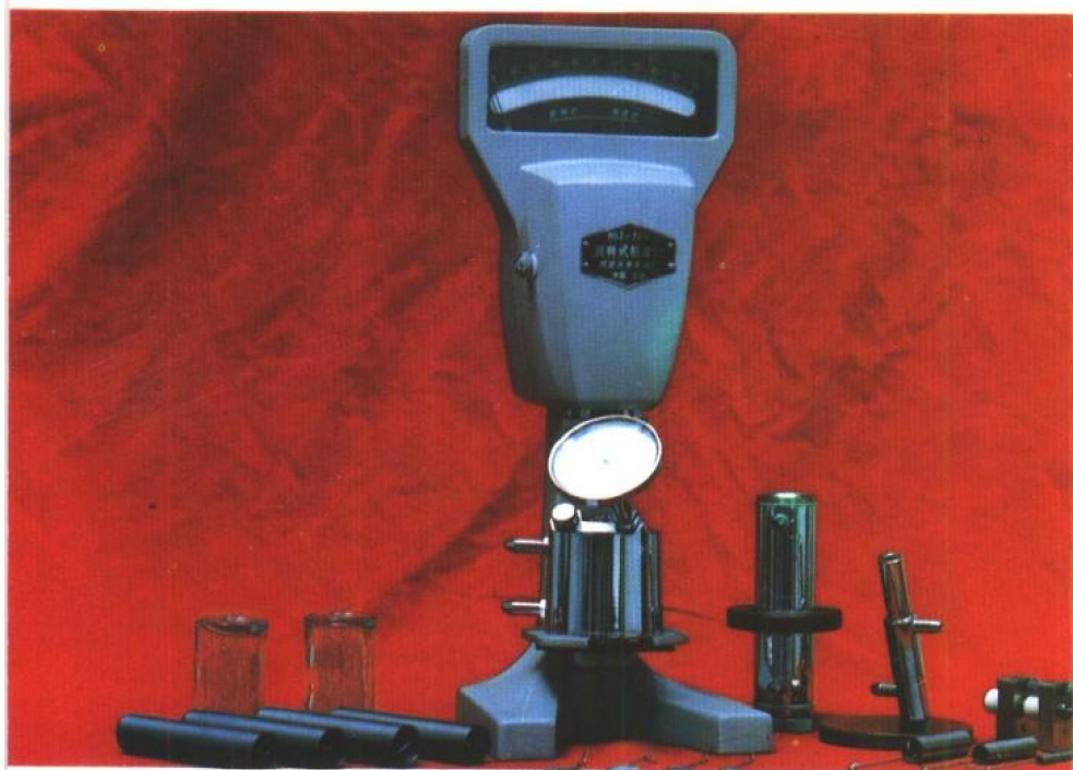
◀ 同济大学机电厂生 产的 DNJ-79 型旋转式 粘度计, 1987 年度被评 为国优产品
