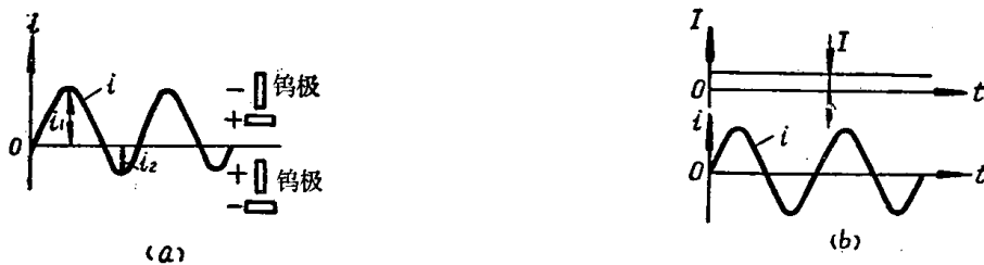
图 1—2 交流钨极氩弧焊电流波形图 (a) 交流电流波形；(b) 交流电流及其直流分量。
