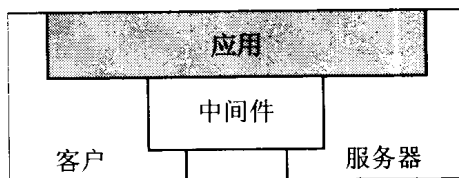
图 3-1 基本的客户机 / 服务器模型
