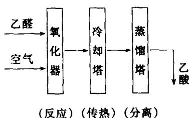
由以上三个例子可看出：①每个生产过程分别由一系列基本的工序，即基本操作所组成；②不同生产过程之间有共同性的单元操作。例如三种生产中都有传热和反应的单元操
