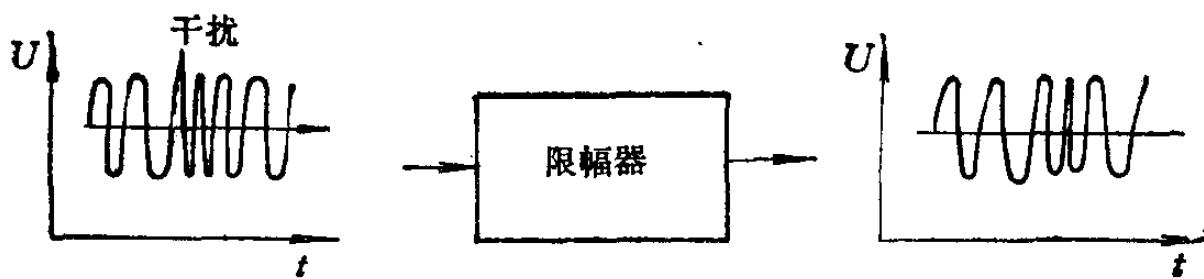
图1-6 调频收音机的限幅作用
