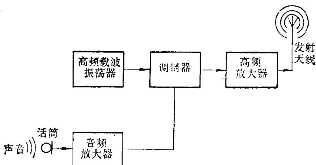
图1-2 无线电广播发射机的方框图
