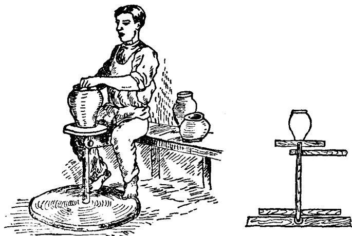
图1—1 古代陶工用旋盘示意图
