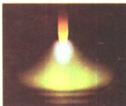
图12 低压气体中的TIG 电弧 (D.C.S.P.) P=32mmHg, 水冷铜板, 电极 \phi 4 \text{ mm} 弧长15mm, 200 A, 采用滤色镜
