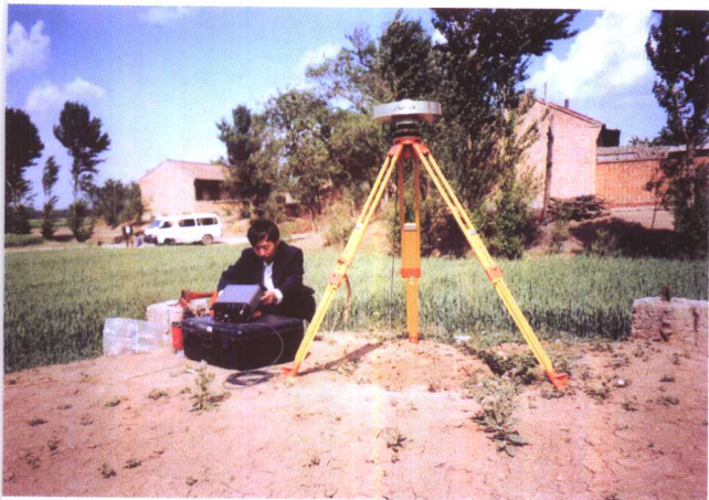
野外作业人员在天津武清区 80 平方公里矢量化测图工作中用 GPS 技术作控制测量
