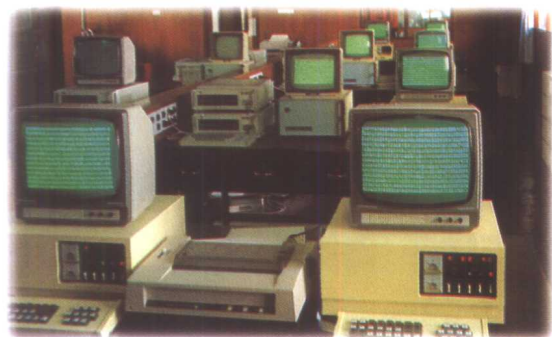
杭州自动化研究所研制的JZ-4A型、CCRT-II A型、CCRT-II B型汉字显示控制器，可与国内流行的微机组成小型汉字信息处理系统
