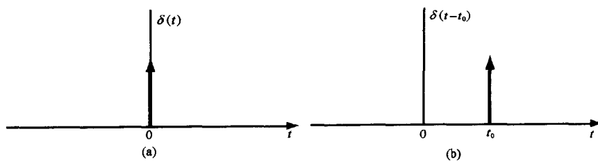
图 1-6 (a)单位冲激函数; (b)平移后的单位冲激函数
