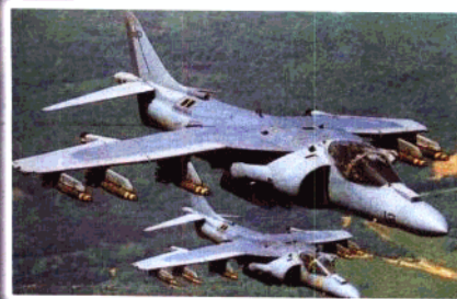
携带着AGM-84“鱼叉”式反舰导弹的美国海军陆战队的 AV-8B 攻击机。
