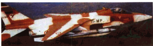
安装在“美洲虎”飞机上的法国“大鳄鱼”式MK2型电子干扰系统。
