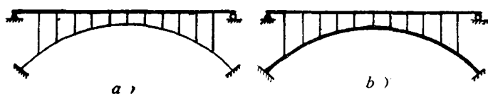
图4-1-7 有推力的组合体系拱 a)倒蓝格尔拱，b)倒洛泽拱
