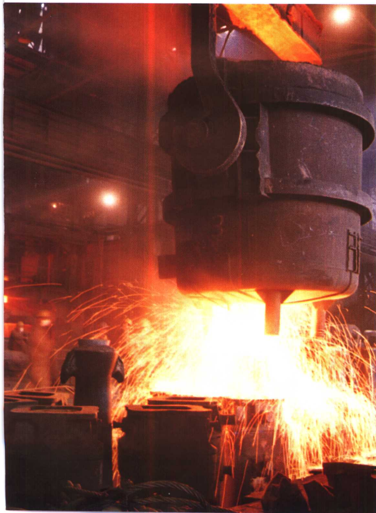
齐齐哈尔钢厂的高炉正在浇注钢锭
