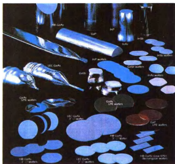
左：各種三五族半導體的晶圓柱和晶片，有的以柴氏法(LEC)製成，有的經液相磊晶法(LPE)處理，亦有以氣相磊晶法(VPE)處理。圖中數字表示晶圓直徑。
