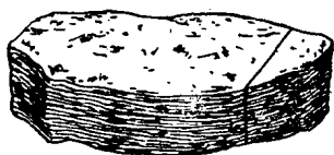
图 1 页岩的切片方位 (垂直层理)
