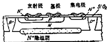
图2.6 集成晶体管的隐埋层
