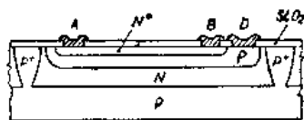
图2.9 发射区扩散形成电阻
