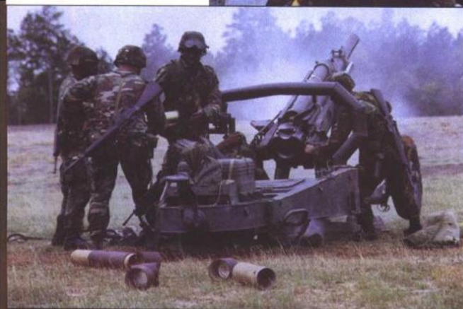
第82空降师 炮兵的M102火 炮正在进行实弹 射击。使用普通 弹，其射程为 11000米；使用火 箭增程弹，其射 程可达15000米。
