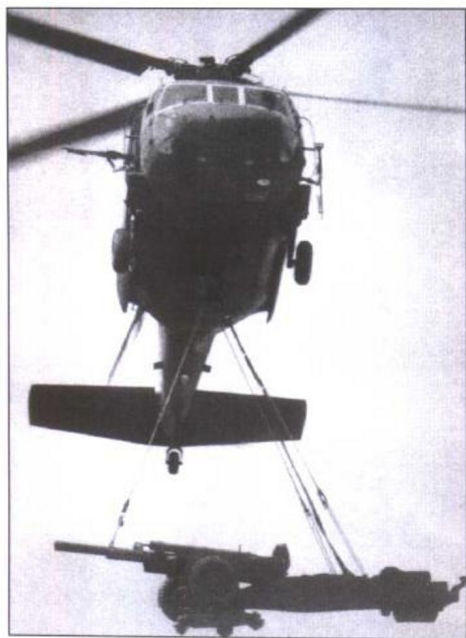
一架UH-60多用途“黑鹰”直升机正为第82空降师炮兵吊运大炮。
