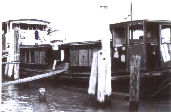
▲ 1945年用日军登陆艇改装的鸿穗号邮船，50年代初在广州沿江路邮局接运邮件到黄埔
