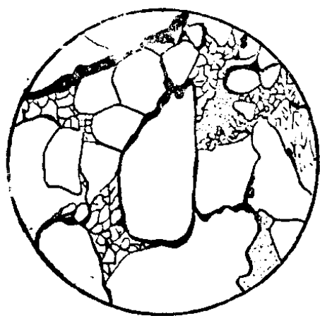
图 1—7, I 粗粒复矿砂层显微镜下的孔隙结构照片 黑色—孔隙空间；点—胶结物。
