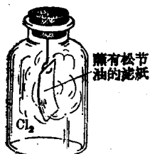
图 1·6 氯气跟松节油反应
