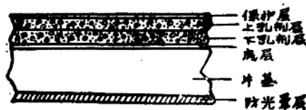
图2—1 感光片结构示意图
