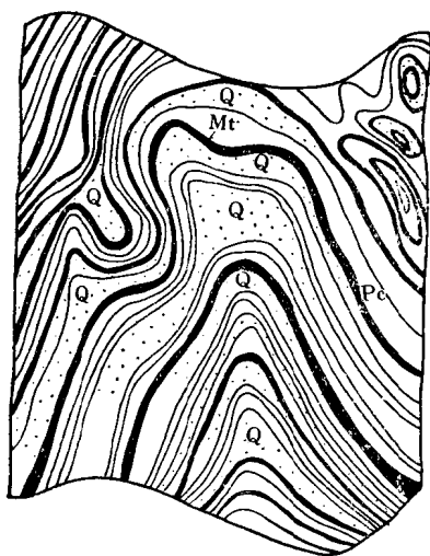
图4 柔皱条带状构造 磁铁矿(Mt)与灰岩(Pc)、石英(Q)呈柔皱状条带 手标本1:1
