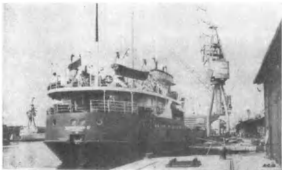
△ 波羅的斯基五十二號輪船在倫敦碼頭裝貨。她是「混合航行」龐大船隊中的一艘，淺底船身使她可以從波羅的海駛出，經過蘇聯的運河系統，抵達黑海。這一類型的船隻還可以從西歐海港運貨到莫斯科的運河碼頭。
