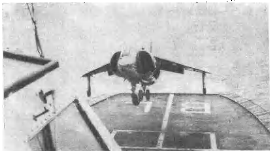
△ 英國霍克爾·塞得利公司的「哈利爾」式飛機，這種飛機是世界第一架可供使用的固定翼垂直起飛飛機，圖為正在英法海峽降落在英國皇家海軍巡洋艦「卜萊克」號直升機起落點上。
