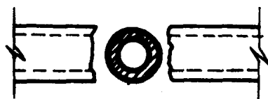
图 1-20 中断式断面图举例
