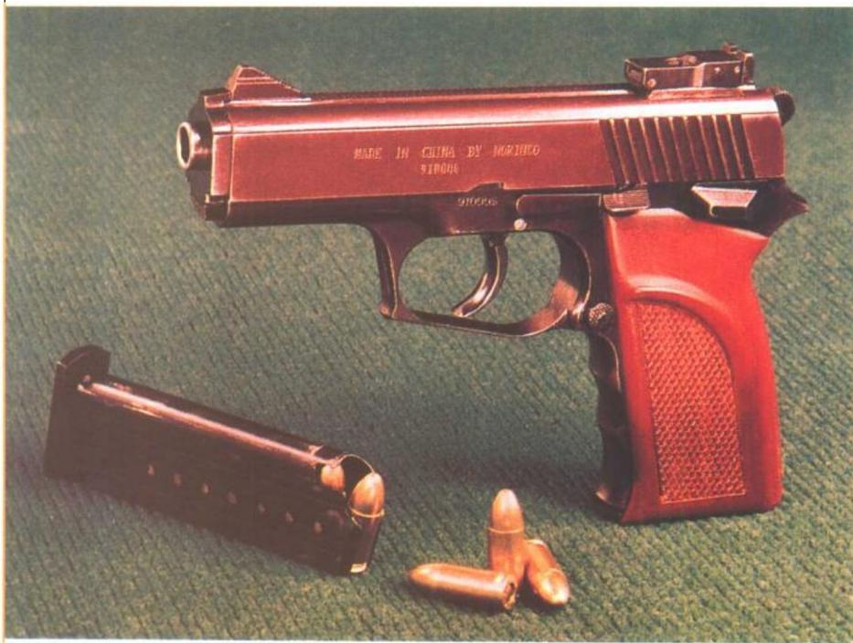
224型9mm手枪是我国90年代自行设计与研制的军民两用型手枪，具有体积小、重量轻、威力大、安全可靠及造型美观等特点。该枪使用9×19mm巴拉贝鲁姆手枪弹，初速330/秒。枪长184mm，枪宽34mm，枪高133mm，枪重0.85kg，枪管长108mm，弹匣容弹量8发，有效射程50m，全枪寿命3000发。
