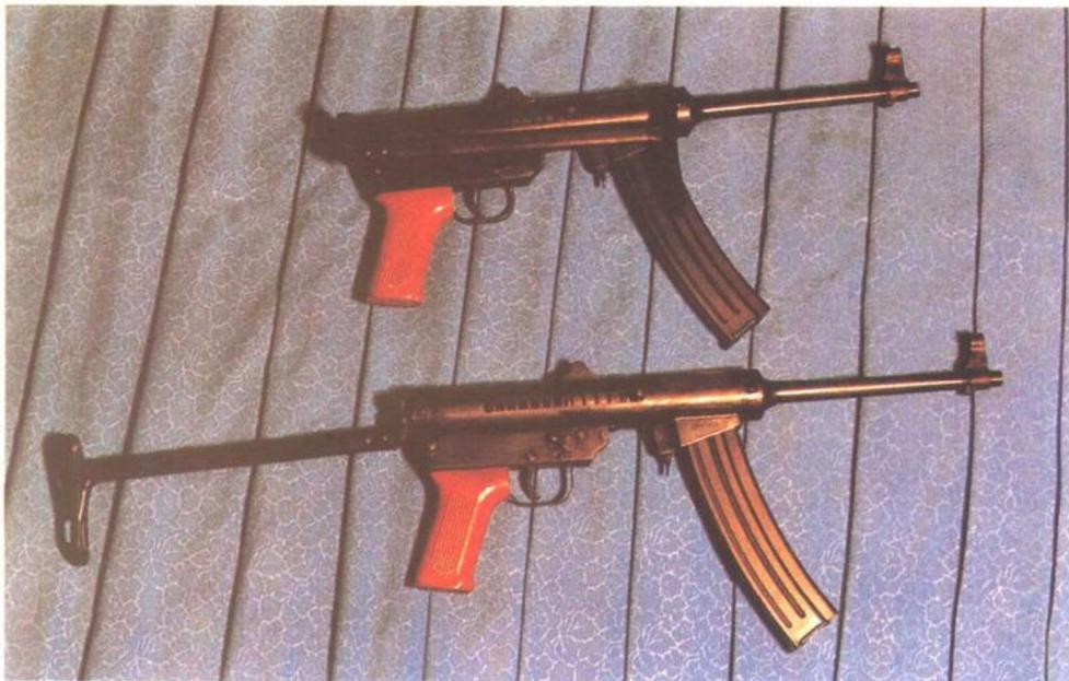
该枪主要用于杀伤200m以内的有生目标。使用51式7.62mm手枪弹，还可使用51-1式7.62mm手枪弹和64式7.62mm微声冲锋枪穿甲弹等。全重1.9kg，初速500m/秒，全枪在行军状态下长444mm，战斗状态下长682mm，弹匣容弹量30发。
