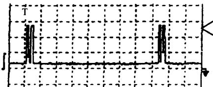
若汽车中具备有自诊断能力和其他串行数据传送能力的控制模块，则串行数据是由发动机控制电脑、车身控制电脑和防滑制动系统或其控制模块产生。
