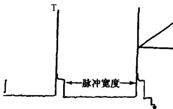
在汽车中产生脉宽调制信号的电路或装置有：初级点火线圈、电子点火正时电路、废气再循环控制、净化、涡轮增压和其他控制电磁阀、喷油嘴、怠速控制发动机和电磁阀。
