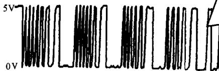
汽车中产生可变频率信号的传感器和装置有：数字式空气流量计、福特数字式进气压力传感器、光电式车速传感器、霍尔式车速传感器、光电式凸轮轴和曲轴转角传感器、霍尔式车速传感器、霍尔式凸轮轴和曲轴转角传感器。
