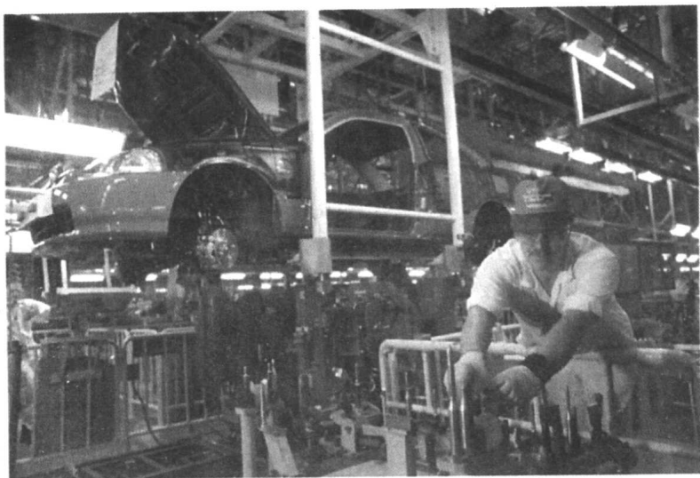
在美国俄亥俄州的东部自由汽车生产厂，一台发动机和一组驾驶套件正被吊进一辆新型西域车身里。旁边是一位生产线同人正在准备下一个模型。
