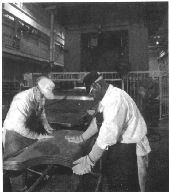
在马里斯维尔汽车生产厂，两名同人正在细心地检查由世界上最大的压模生产线生产出来的轿车门板。
