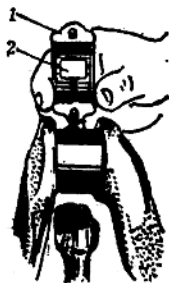
图1-7 用铜片检查轴瓦间隙
