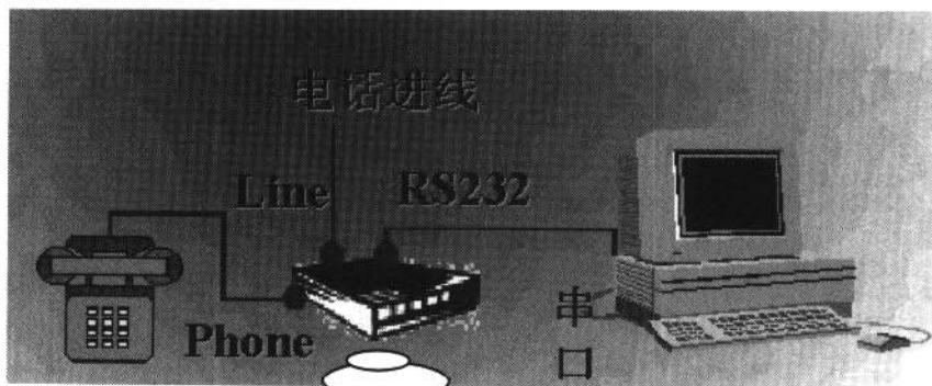
通过拨号方式上网，除计算机和电话线外，最重要的就是 MODEM。MODEM 中文名字是“调制解调器”，俗称“猫”，它是为计算机和电话之间的语言进行互译的设备。按照 MODEM 与计算机连接方式的不同，可分为两大类：内置式和外置式。
