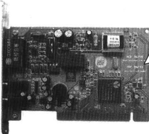
**内置式：** 内置式 MODEM 就是一块像声卡、显卡一样安装于计算机主板扩展槽上的板卡。由于没有了外壳及外接电源，使得这种 MODEM 的售价大大低于外置式 MODEM，但是它安装起来需要打开机箱，比较麻烦，需要占用主板上的一个扩展槽，而且容易受到其他设备的干扰而降低连接质量。
