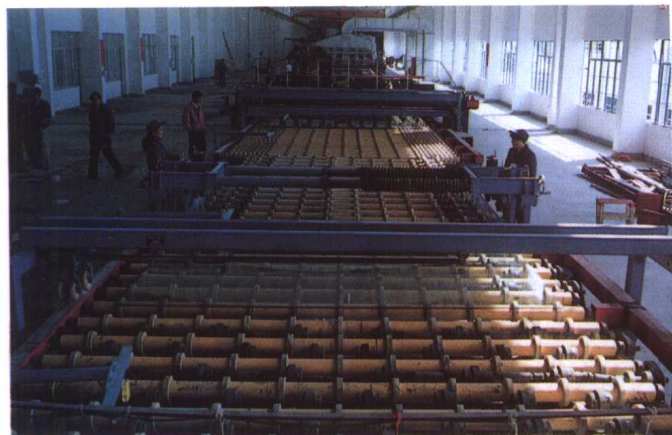
萍乡矿务局新建的年产玻璃 212 万重量箱的浮法玻璃生产线
