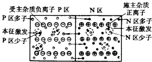
图 1-5 P 型与 N 型区多数载流子与杂质离子
