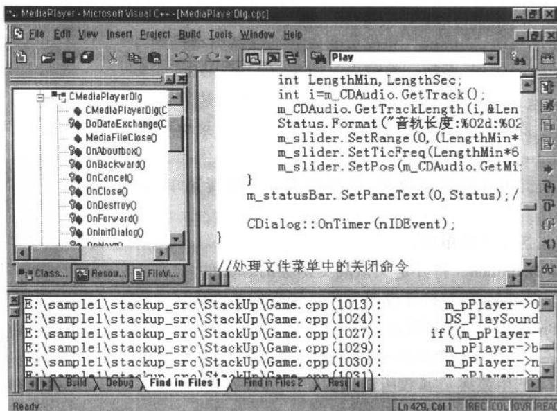
图 1-2 打开一个工程后的工程工作区窗口
