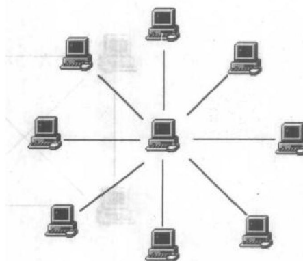
图 1-2 星型网络的拓扑结构
