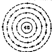
图 1-1 锗的原子结构
