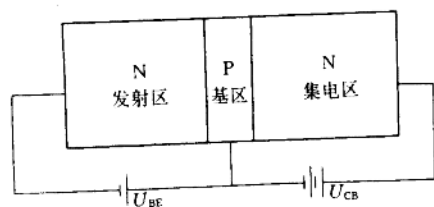
图 1—8 三极管结构示意图
