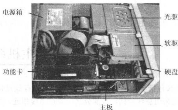
图 2-2 主机箱内部结构示意图
