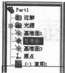
3. 单击【圆】按钮→由原点绘制一个圆→单击【标注尺寸】按钮→标注圆的直径→右击选择【选择】命令，停止标注尺寸→双击尺寸，将其修改为 120。
